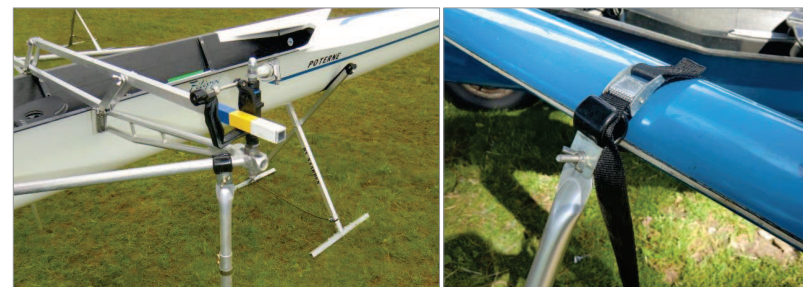
Het gebruik van de fixeërstangen bij een boot met klassieke- en een met vleugelriggers
