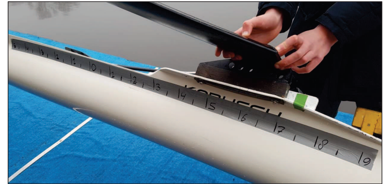
Markeringstape voor het bepalen van haalkwadranten
